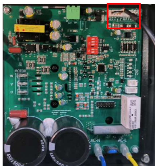
Kommunikationsport mellem ventilatormoto- rens kort og hovedkortet COM1)
